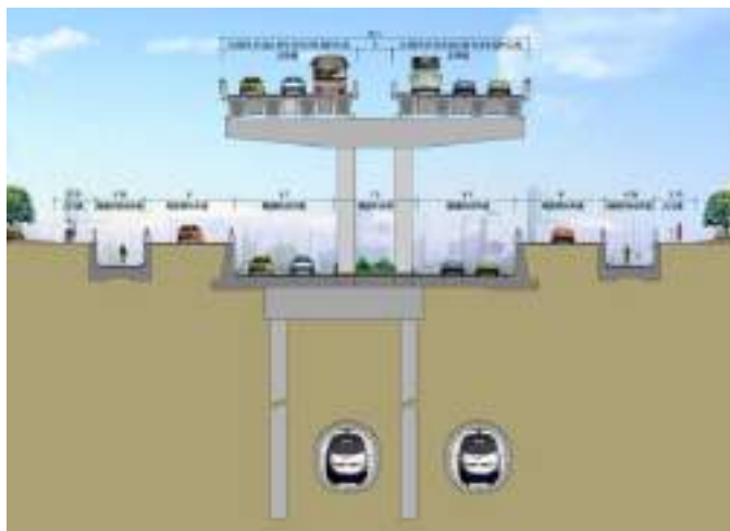
图 1-10 跨线桥双柱方墩设计图
